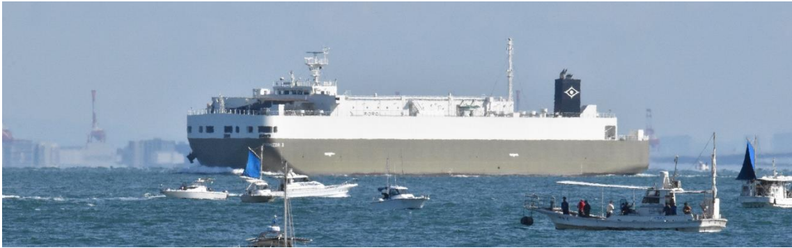
鋼材運搬船「ばいおにあ A」のバージ型の船型がよくわかります。
